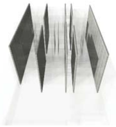
Muros de carga de concreto
