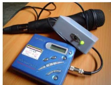
Amplificador portátil de 9 volts, micrófono dinámico y reproductor de minidisco
