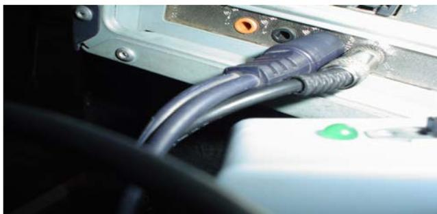
Conexión de amplificador portátil a la entrada de línea y conexión de salida de línea de la tarjeta de sonido.
