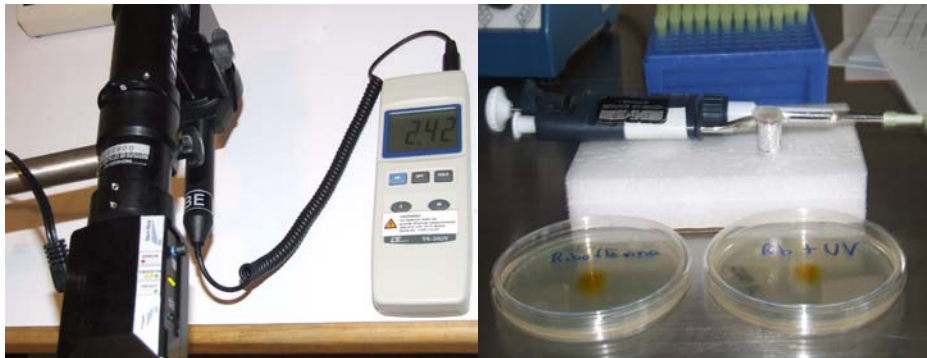
Figura 13 se calibra el Crosslinking y se aplica la RB en las 2 cajas con micropipeta 5 microlitros cada 10 min Fotografia tomada para este protocolo
