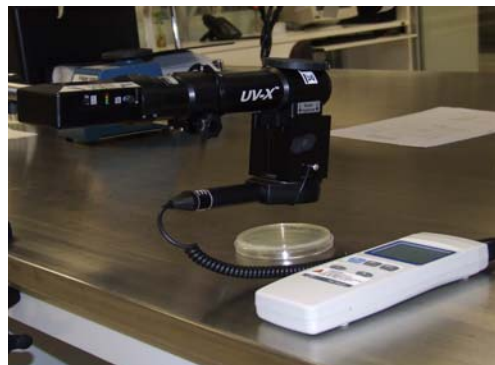
B: Lampara de crosslinking con filtro calibrador
