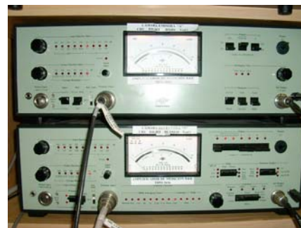
Figura 3.1. Conexión de dispositivos para la adquisición de niveles de presión sonora con la tarjeta de sonido de una PC para la calibración del instrumental.
