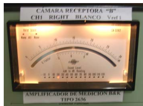
Figura 3.3. Carátula del amplificador de medición indicando un NPS de 58\text{dB} con la escala correspondiente y las posiciones críticas de aguja.
