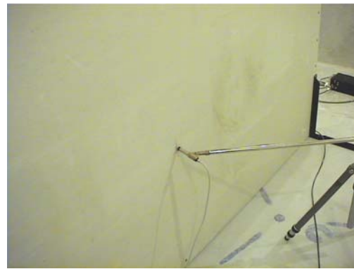
Foto 4.2. Montaje del micrófono para la medición del sonido transmitido por el espécimen.
