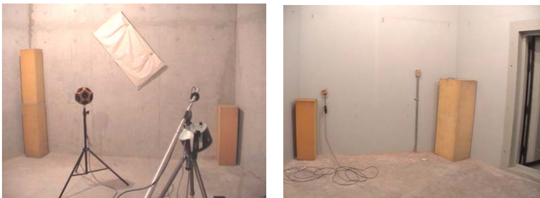
Foto 3.3 Acondicionamiento acústico de la cámara de transmisión con material absorbente.
