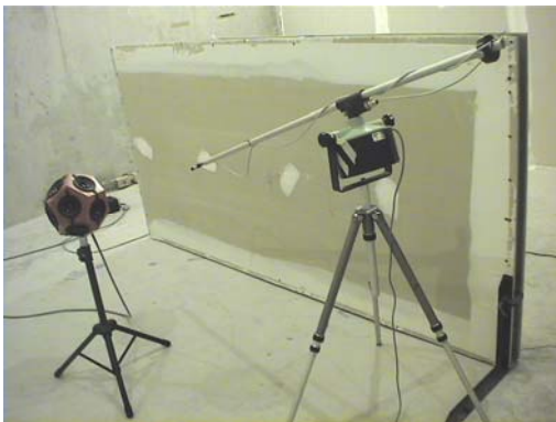
Foto 4.1. Montaje de la fuente sonora y el micrófono para la medición del sonido incidente en el espécimen.
