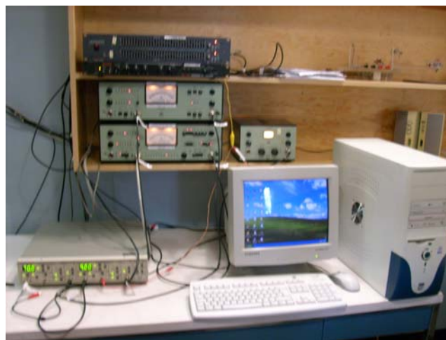
Foto 3.4 Instrumental empleado en el exterior de la cámara de transmisión para adquirir y procesar las señales de las cámaras emisora y receptora.
