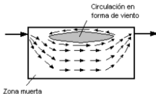
Figura 14. Flujo con circulación en forma de viento Ref. Metcalf y Eddy, 2003
