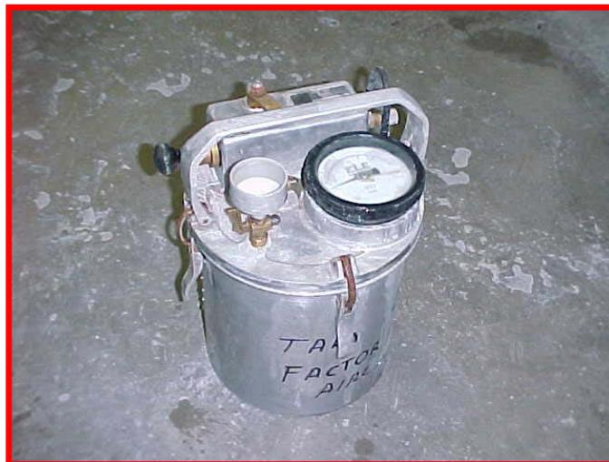
**Foto 3. 6** Determinación del contenido de aire en el concreto fresco por el método de presión
