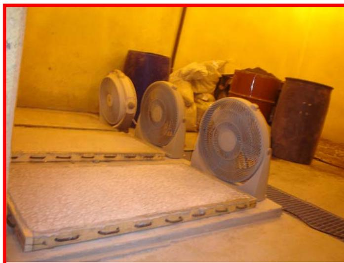
Foto 3.9 Cuarto de condiciones variables donde se almacenaron las losas para inducir el agrietamiento del concreto.
