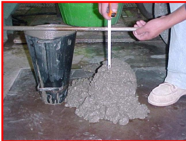
**Foto 3. 4 Determinación del revenimiento del concreto fresco**
