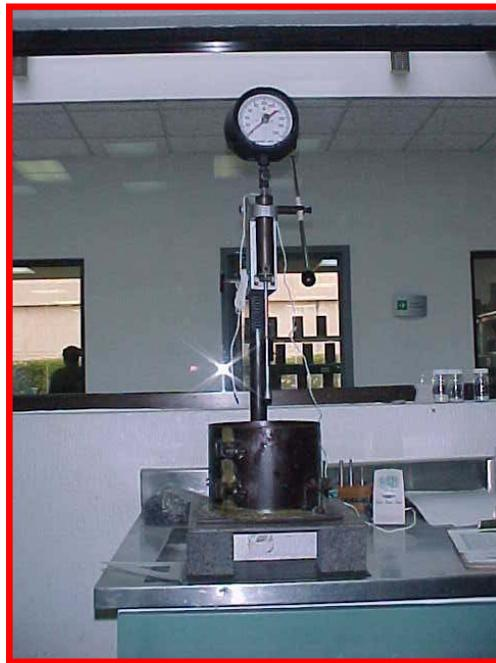
**Foto 3.7 Determinación del tiempo de fraguado inicial**
