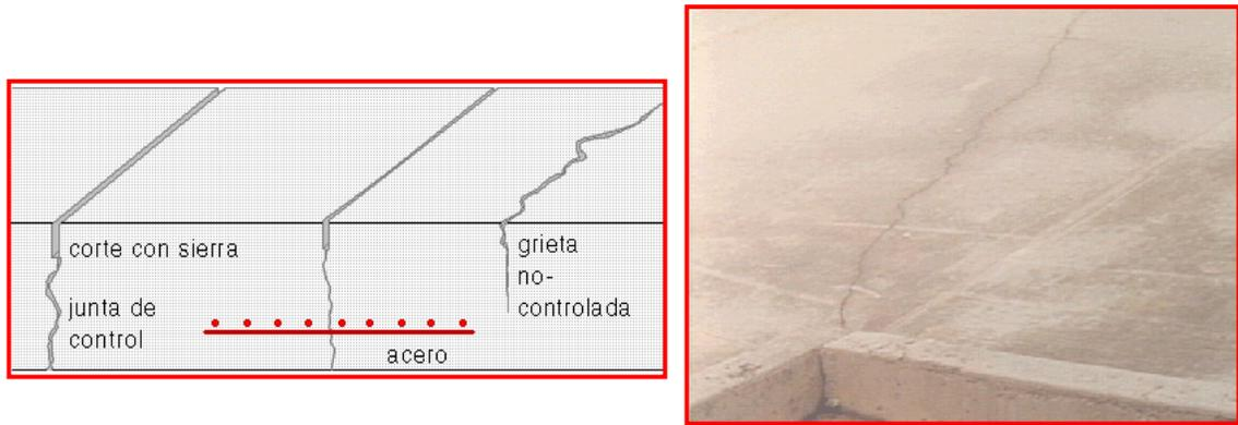
**Fig. 1.10 Representación esquemática y fotográfica del agrietamiento debido a la contracción por secado del concreto**
