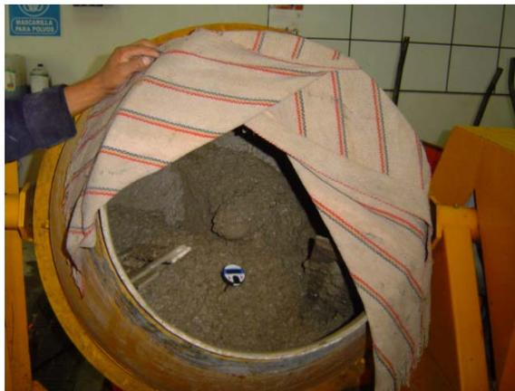
**Foto 3.3 Mezcladora de concreto para la elaboración de mezclas en el laboratorio y determinación de la temperatura.**
