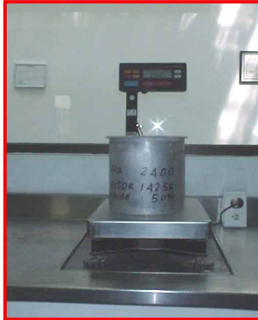
**Foto 3.5** Determinación del masa volumétrica o masa unitaria del concreto fresco.
