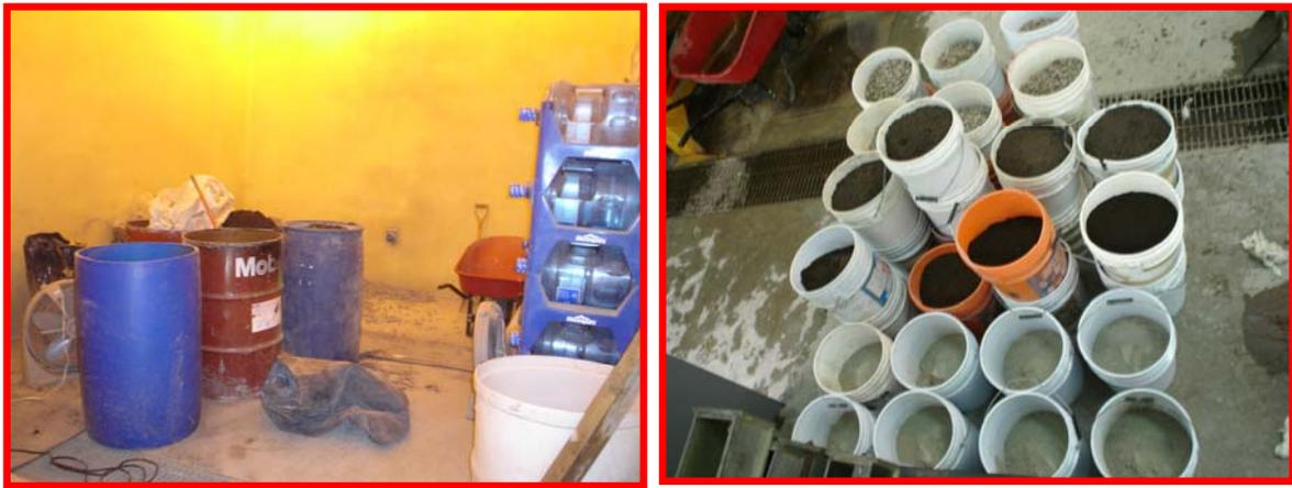
**Foto 3.1** Los ingredientes de la mezcla fueron almacenados en el cuarto de condiciones variables para simular condiciones reales y dosificarlos en las mismas condiciones al realizar la mezcla.
