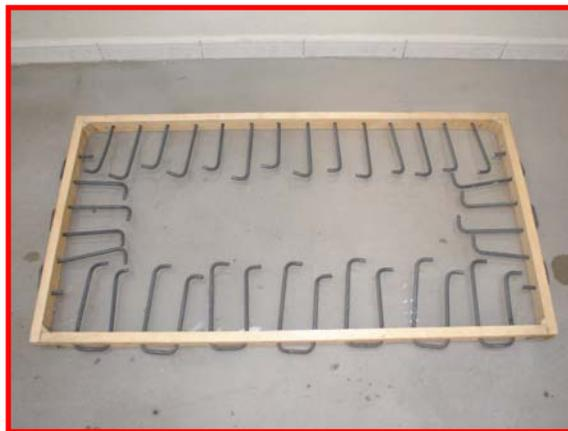
**Foto 3.2** Modelo propuesto para estudiar la densidad o el potencial del agrietamiento durante las primeras 48 horas.
