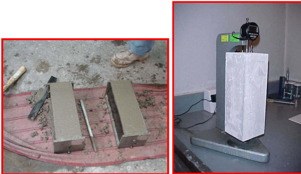
**Foto 3.14** Elaboración de especímenes para determinar la contracción por secado del concreto a los 56 días de edad.
