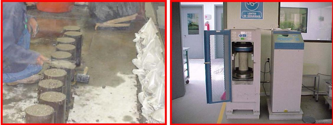
Foto 3.11 Elaboración y ensaye de especímenes para la determinación de la resistencia a compresión.
