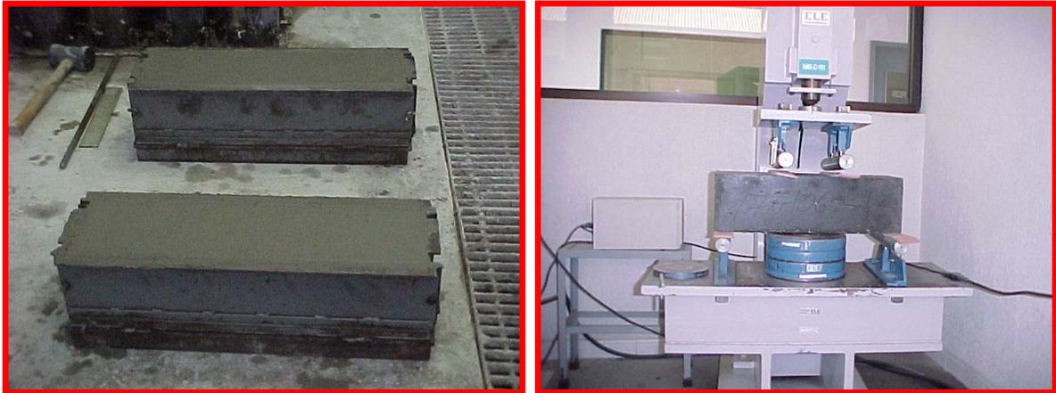
**Foto 3.13** Elaboración y ensaye de vigas para determinar la resistencia a flexión o módulo de ruptura.
