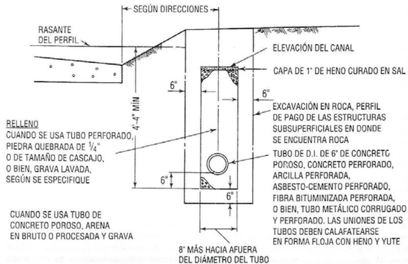
Figura No II.12 Diagrama de un desagüe inferior.
