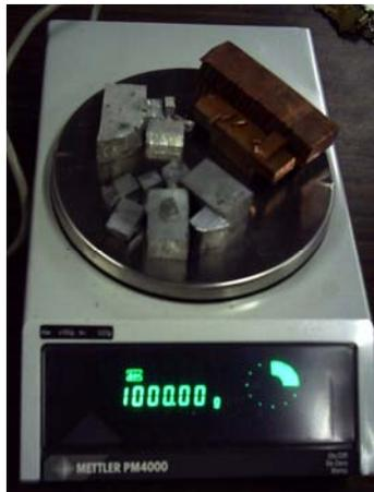
Fig. 3.1 Material cortado y pesado
