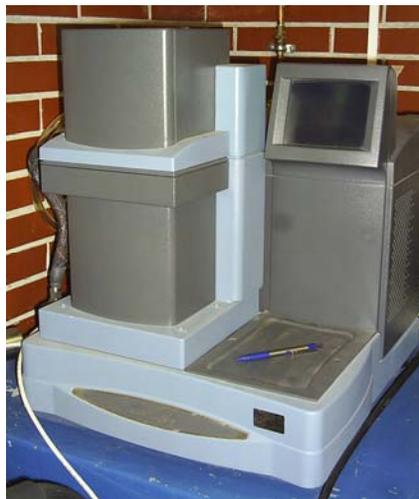
Fig. 5.6 Equipo DMA Q800
