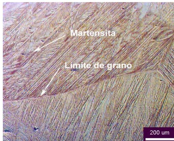
Fig. 5.3 CuAlNi visto en microscopio óptico
