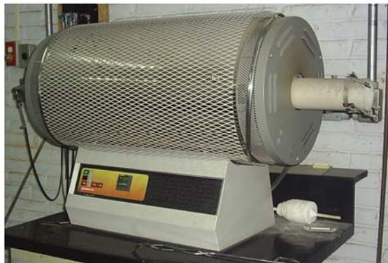
Fig. 3.8 Horno de tubo para proceso de homogeneizado
