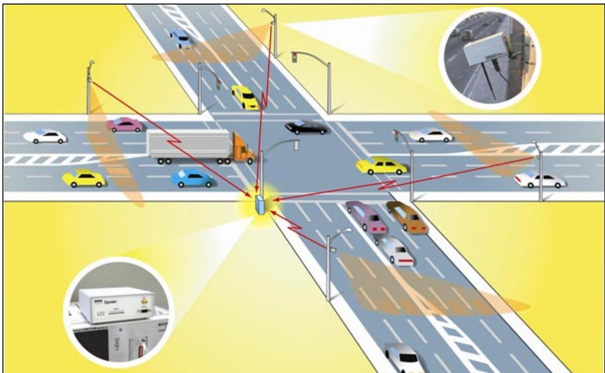
**Figura 5.11 Detector de tráfico por microondas sobre postes**
