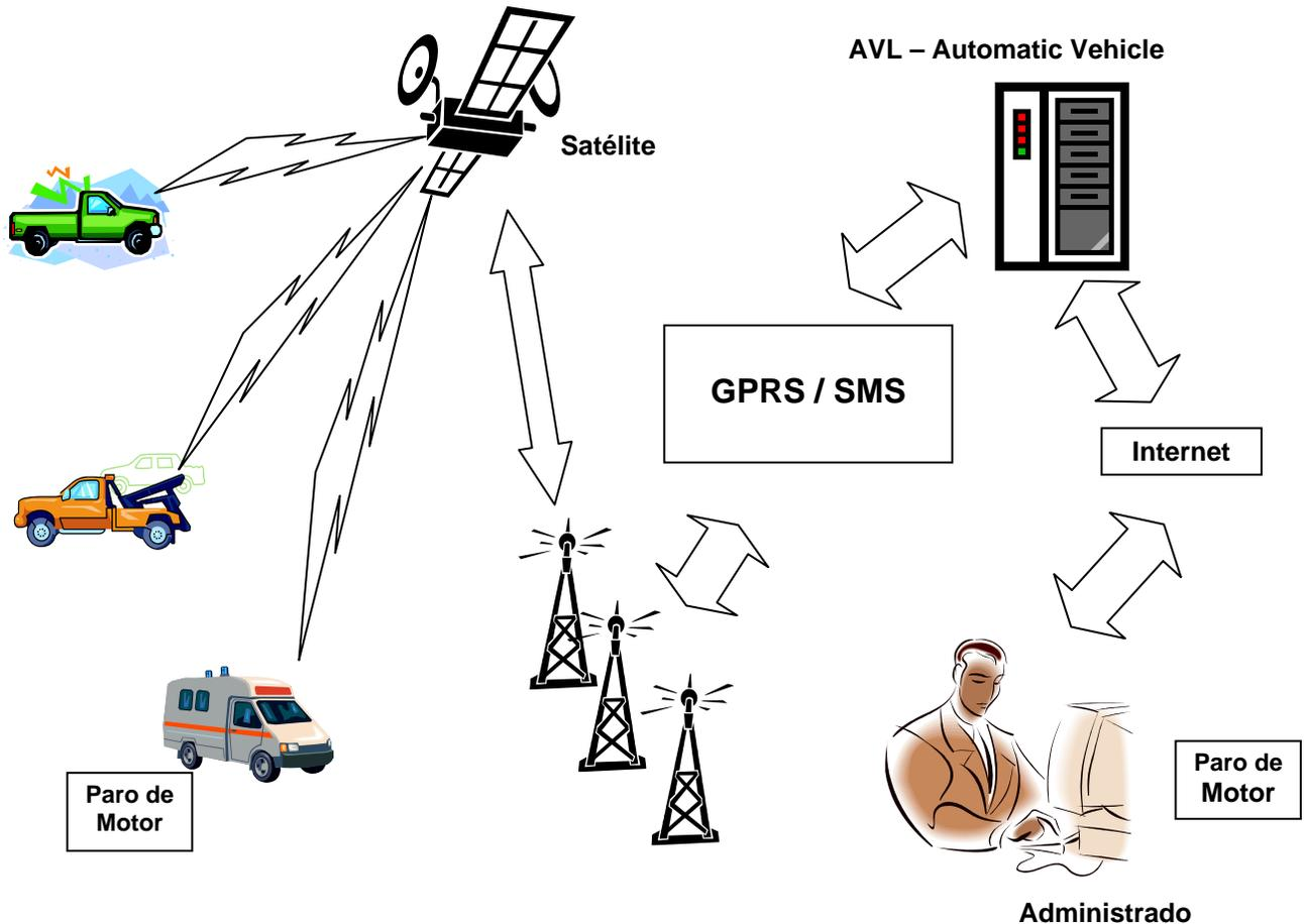
**Figura 4.23 Sistema de localización de vehículos GPS**
