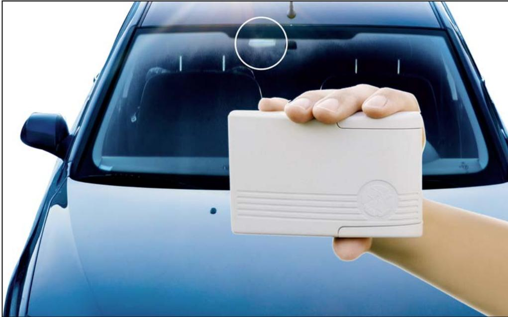
**Figura 5.13 Transponder; dispositivo con tecnología RFID**
