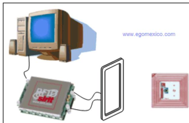
**Figura 5.12 Identificación por radiofrecuencia**
