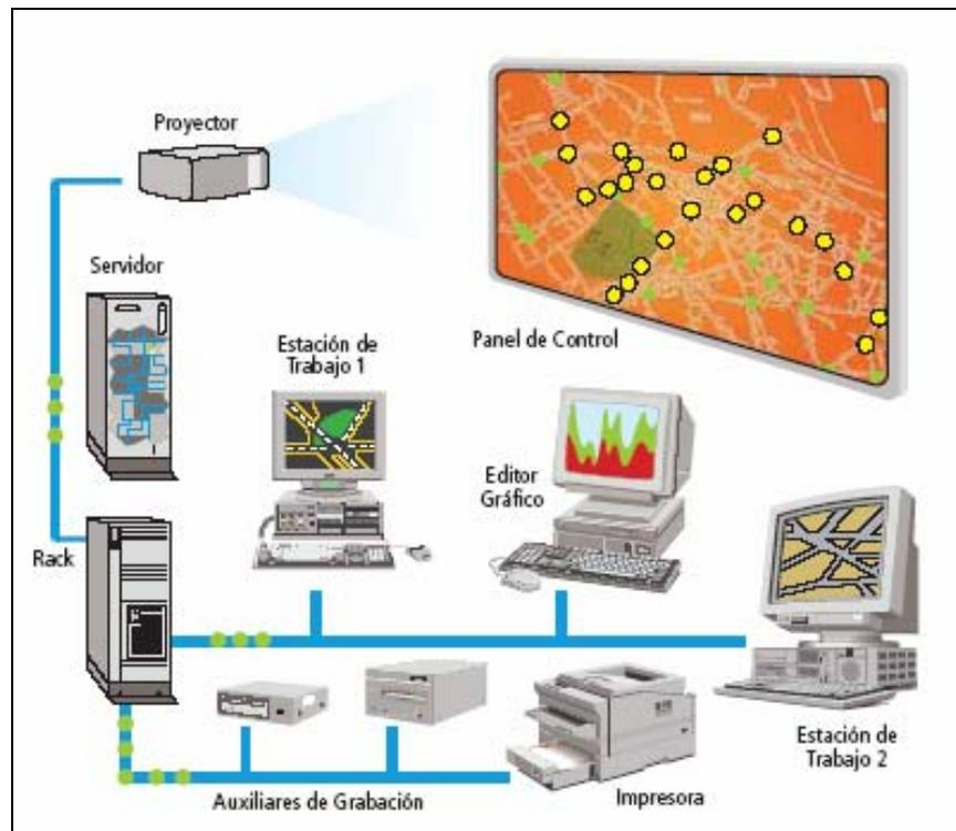
**Figura 5.27 Sistemas Centralizados de Control de Semáforos**
