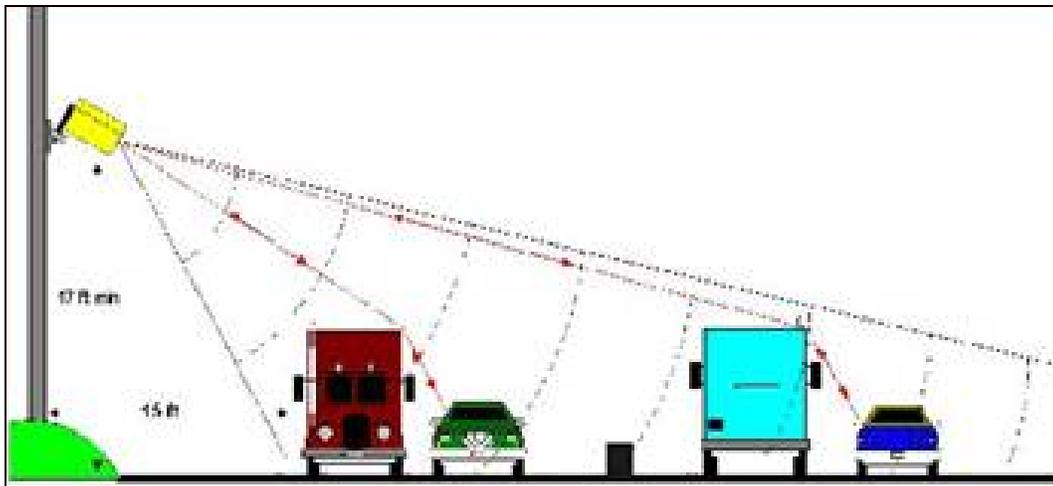
**Figura 5.10 Esquema de detección del sensor RTMS**
