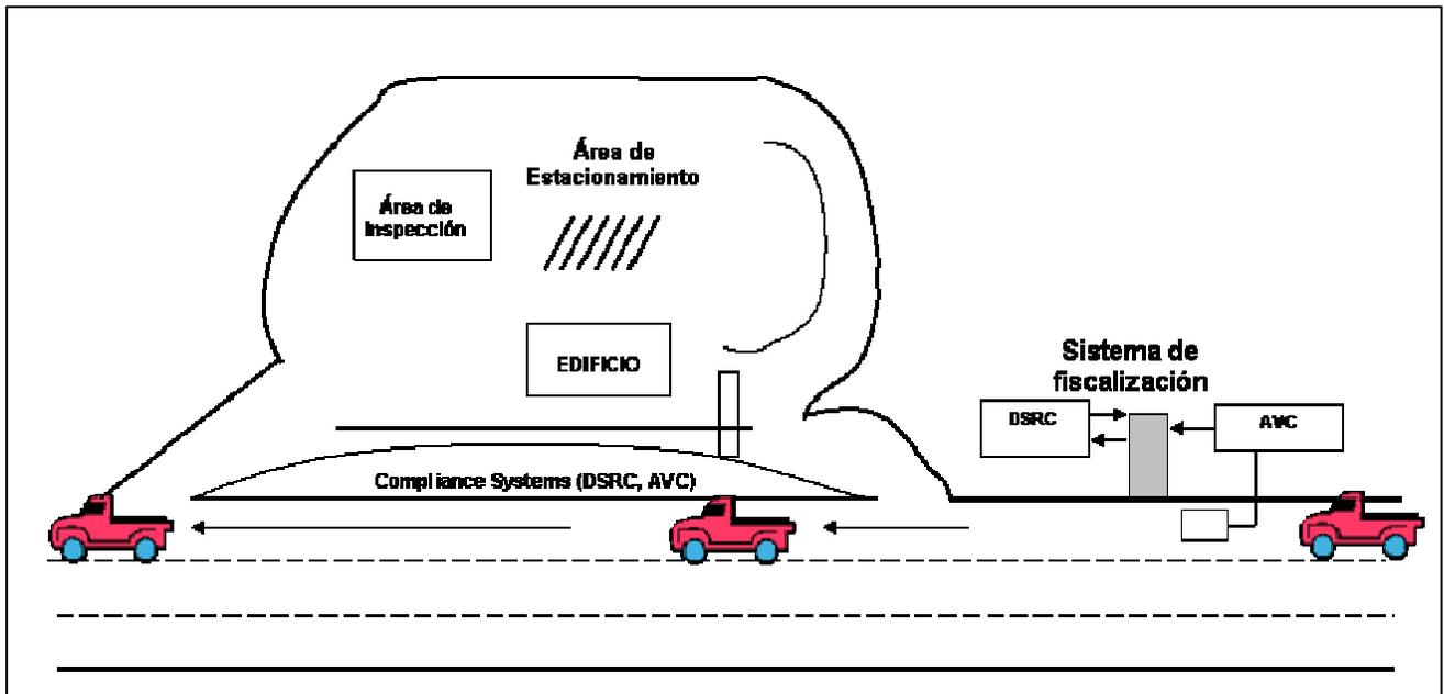
**Figura 2.8 Concepto operativo de una estación de inspección**
