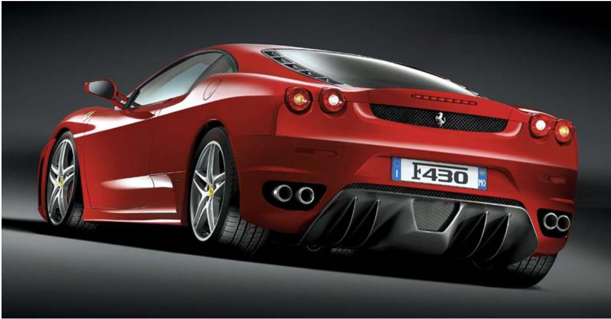
Ferrari F430 con piso plano y tuneles inferiores para lograr una mejor estabilidad
