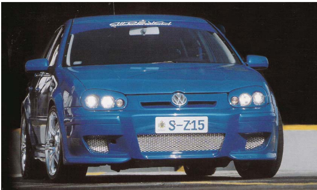
Golf IV con kit de poliuretano fabricado por proceso de RIM
