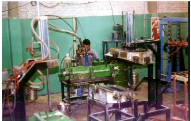
Moldeo de pieza por proceso de RTM
