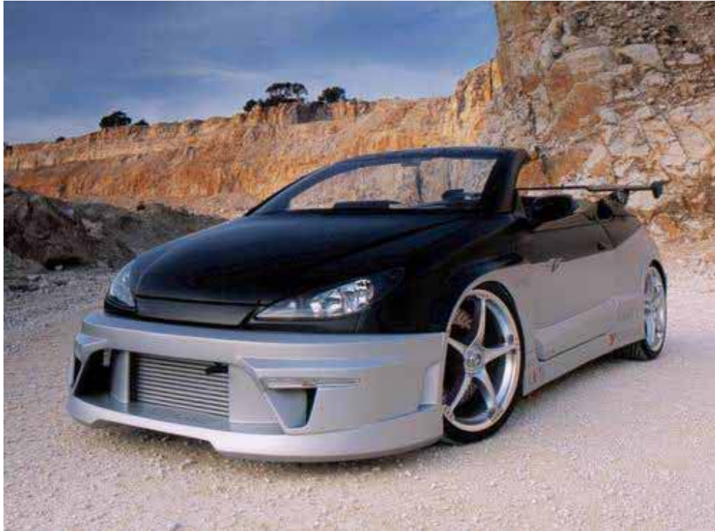
Peugeot 206 con kit de plástico reforzado con fibra de vidrio fabricado por proceso de RTM
