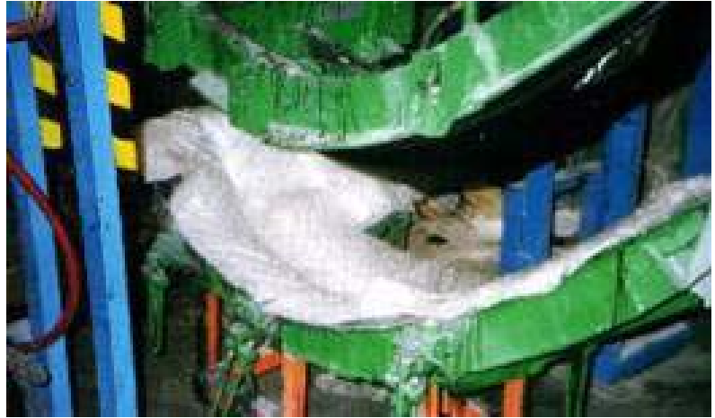
Molde para producir pieza de RTM con preforma de fibra de vidrio
