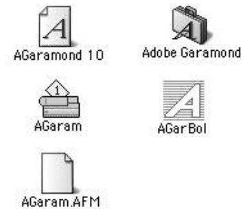
Muestra de una fuente PostScript, que se conforma de un archivo de impresión, uno de trazo, uno de mapa de bits y uno de instrucciones de la fuente.
