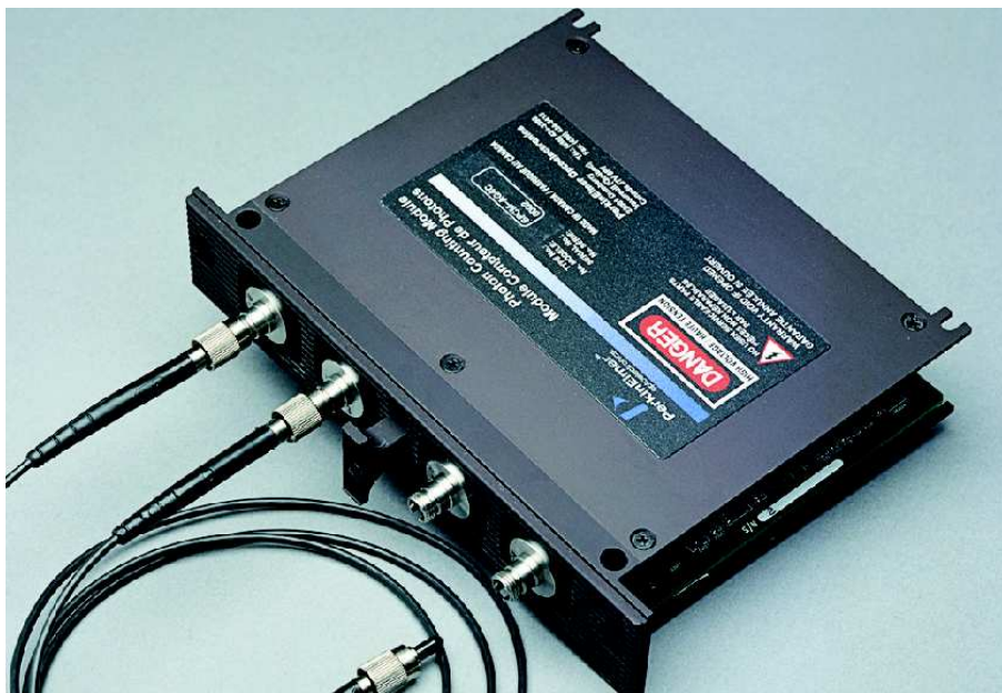
Figura C.2: Fotografía del módulo contador de fotones individuales SPCM-AQ4C de 4 canales.
