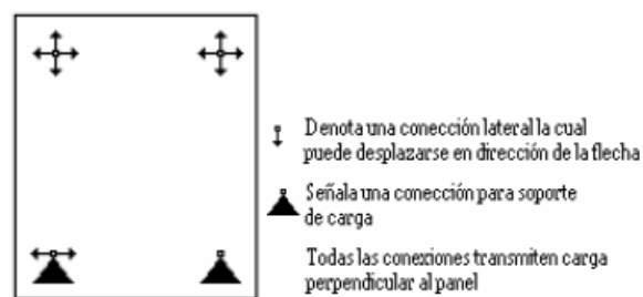
Fig. 1.10.4- Panel típico de piso a piso
