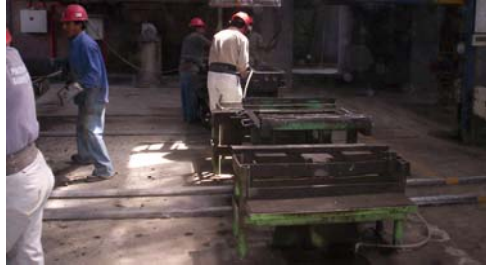
Fig. 1.11.10- Mesas vibratorias de concreto
