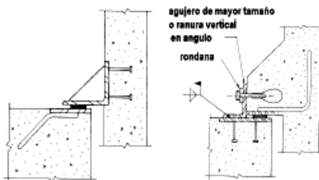
Fig. 1.10.8- Conexiones de soporte o apoyo vertical
