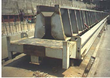
Fig. 1.11.6- Molde metálico autotensible de sección I
