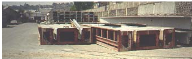
Fig. 1.11.7- Molde autotensible de acero (trabe doble T)
