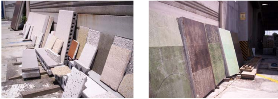
Fig. 1.10.2 y 1.10.3- Acabado integral en un elemento prefabricado de concreto
