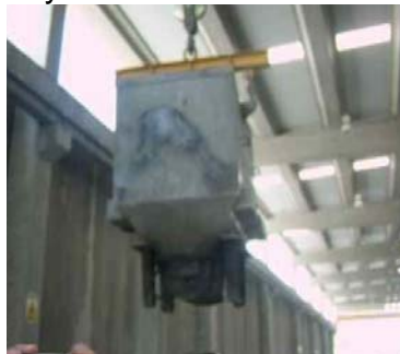
Fig. 1.11.9- Equipo para depositar concreto
