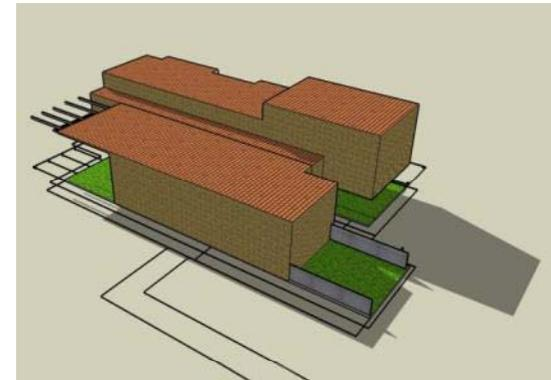
MUROS DE ADOBLOCK Y TEJA DE CERÁMICA EN CUBIERTA CON ARMADURA DE MADERA
