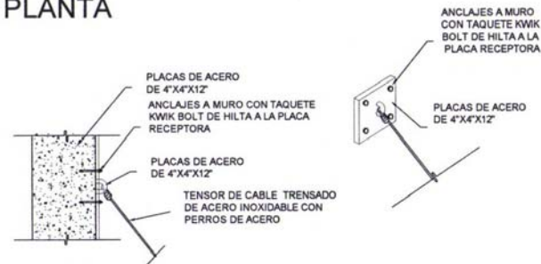
ANCLAJE DE TENSOR DE SOPORTE
