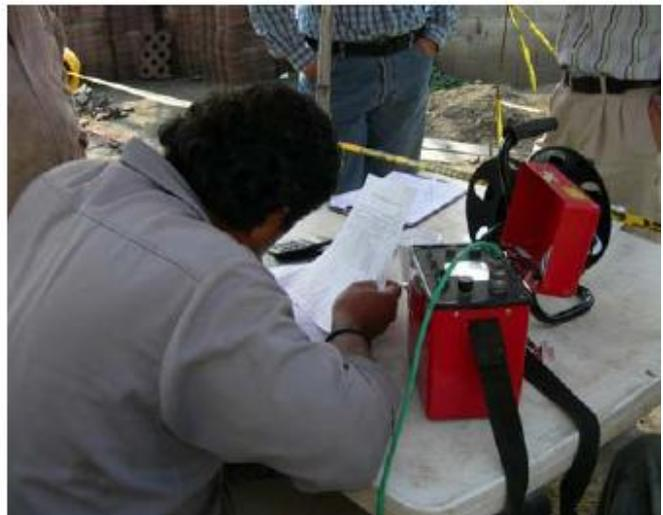
**Fotos 15, 16, 17 y 18.** Para determinar las condiciones de presión de poro se realizó un sondeo con piezocono y cinco lecturas distribuidas en los primeros 29.20 m; es decir, en la formación arcillosa superior. Es importante comentar que en el proyecto de la primera etapa se instaló una estación piezométrica, de la que se obtuvieron mediciones. Con la información obtenida se pudieron calibrar los resultados obtenidos con el piezocono.
