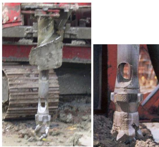
**Figura 9.** Tubería Tremie y cabeza de perforación
