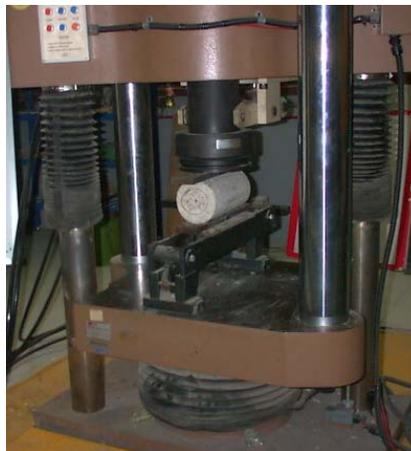
Esta prueba permitirá determinar la resistencia a la tensión del concreto hidráulico mediante la compresión diametral en especímenes cilíndricos.
