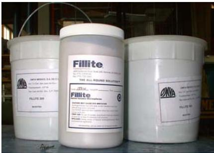
Las microesferas cerámicas huecas, también llamadas cenosferas, son microesferas de silicato huecas e inertes usadas primordialmente para reducir el peso de plásticos, hules, resinas, etc.
