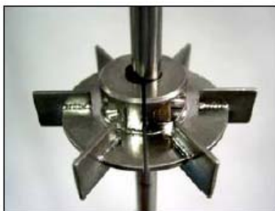
Figura 32. Turbina Rushton de seis palas planas
