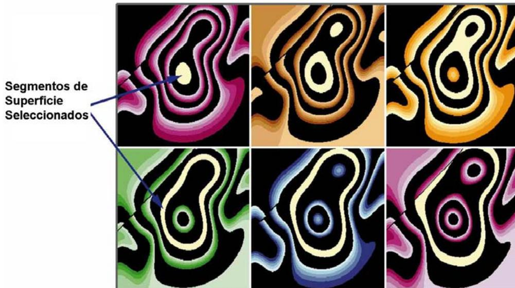
Figura III.21. Seis cortes horizontales de porciones de datos, cada 12 ms. Sólo los picos se muestran en cada porción. Los elementos de superficie seleccionados son porciones del horizonte en la figura III.20 (Dorn, 1998).
