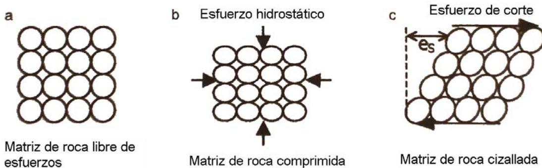
Figura II.5. Comparación de estados de matrices de roca para diferentes estados de esfuerzos, (a) roca libre de esfuerzos, (b) roca comprimida y (c) roca cizallada (Lines, 2004).
