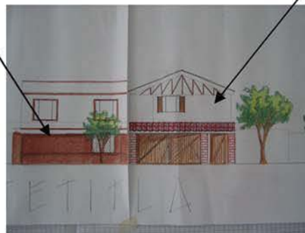
Muro de tabique con aplanado fino con pintura vinílica blanca
