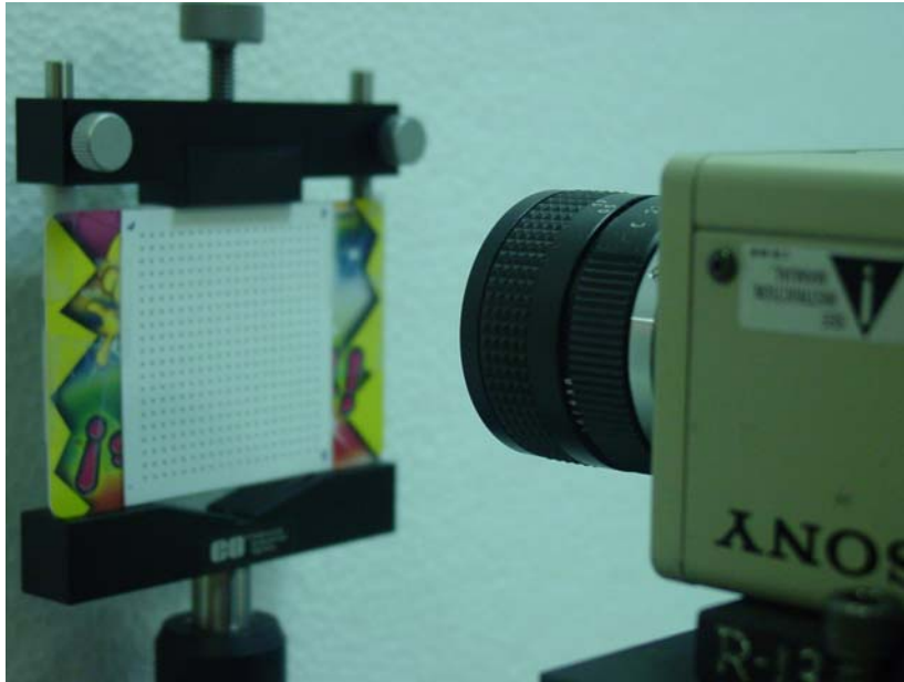
Figura 4.5: Arreglo experimental para medir la distorsión
