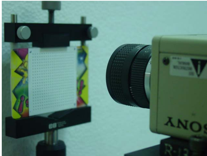
Figura 4.5: Arreglo experimental para medir la distorsión
