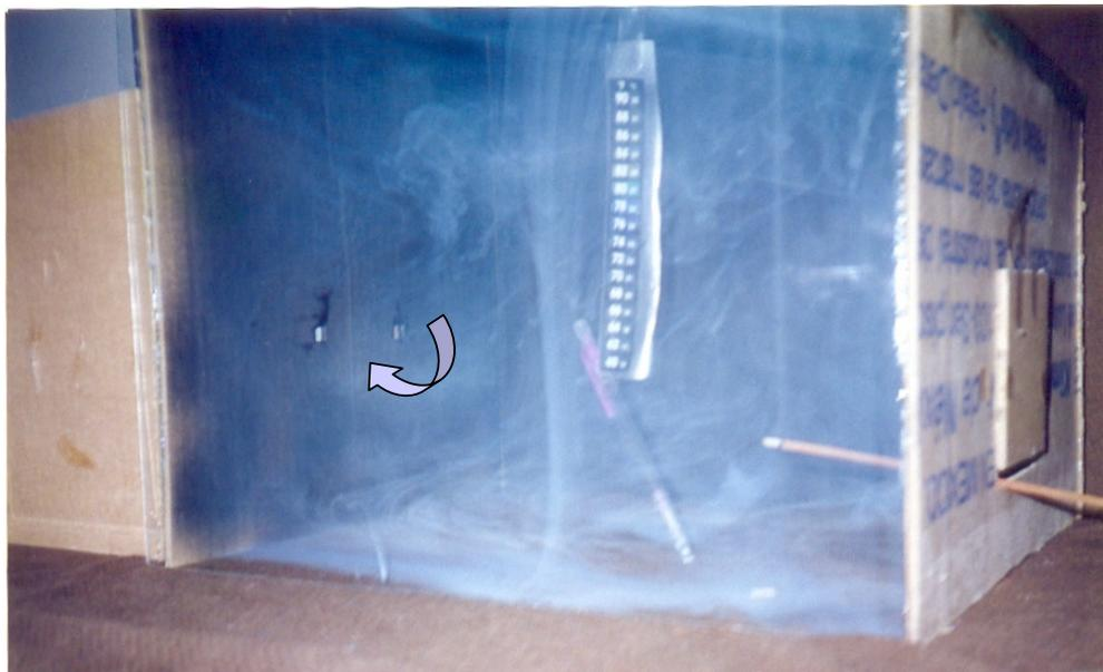
IMAGEN 25. EN ESTA IMAGEN SE PUEDE DISTINGUIR COMO EL HUMO ES ATRAÍDO POR EL CALOR DEL ALUMINIO A TRAVÉS DE LOS ORIFICIOS.
