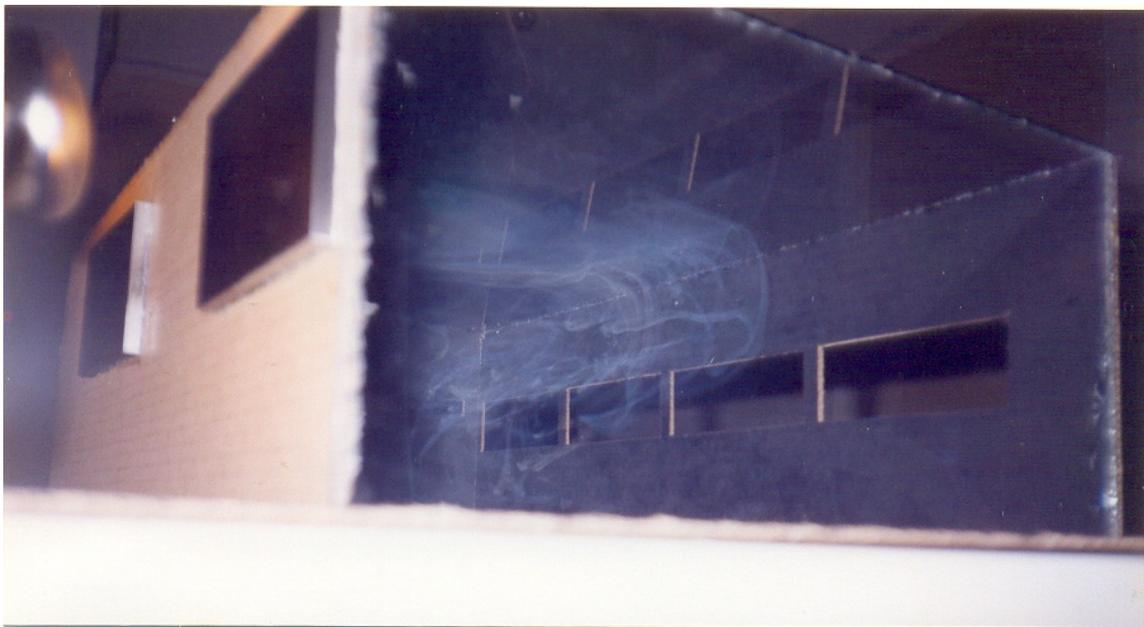
IMAGEN 32. LA APERTURA ÚNICAMENTE DE LAS VENTANAS ESTE, FACILITA LA SALIDA DEL AIRE INTERIOR, PUES CONTRIBUYE A IMPULSARLO CONTRA LOS COLECTORES.
