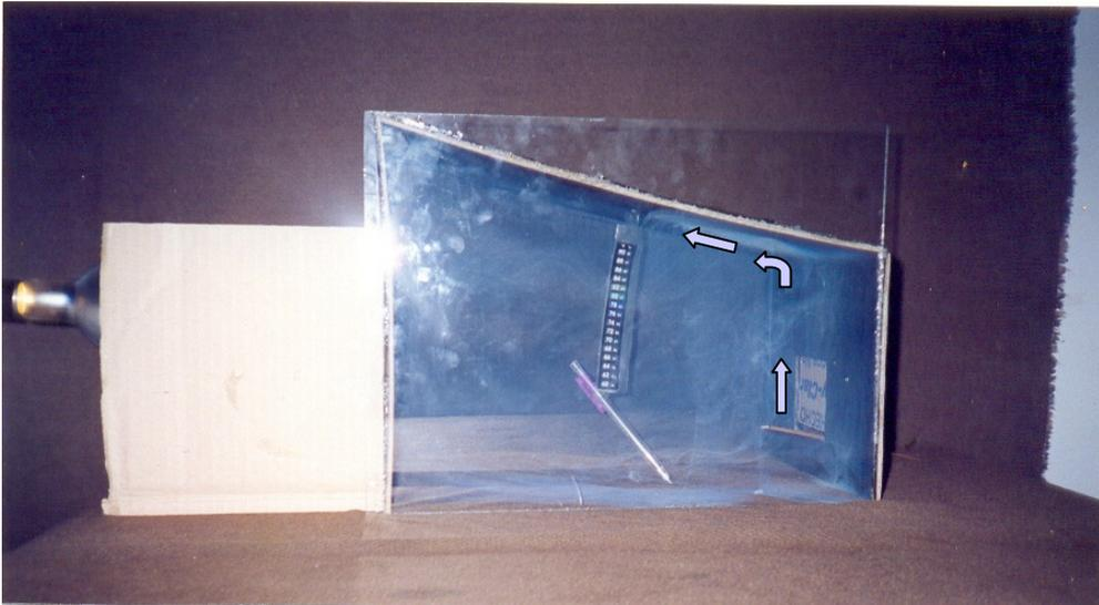
IMAGEN 23. EN ESTA IMAGEN SE MUESTRA EL ESCENARIO DE LA PRIMER PRUEBA. SE PUEDE APRECIAR QUE EL HUMO DE LA VARA DE INCIENSO SE ELEVA Y RECORRE LA SUPERFICIE DEL TECHO DE MANERA ASCENDENTE.
