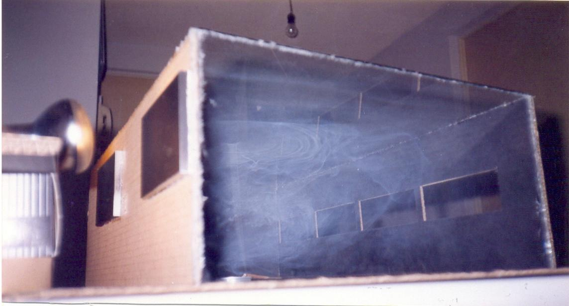
IMAGEN 33. LA APERTURA DE LAS VENTANAS NORTE Y ESTE PROVOCA UN ENCUENTRO DE VENTILACIÓN, POR LO QUE EL HUMO ADQUIERE UN MAYOR MOVIMIENTO Y SU EVACUACIÓN RESULTA CON MÁS VELOCIDAD QUE LOS CASOS ANTERIORES.
