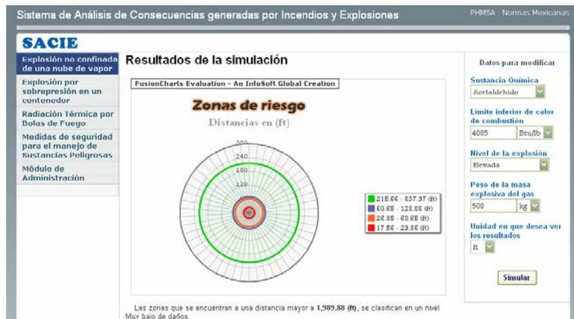
Figura 3.15 Nueva Simulación de la explosión no confinada de una nube de vapor
