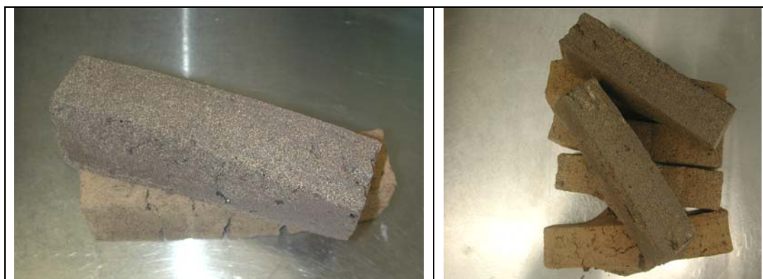
Figura 4.13 Especímenes que sufrieron deformación al ser quemado a una Temperatura de 1200 ° C.
