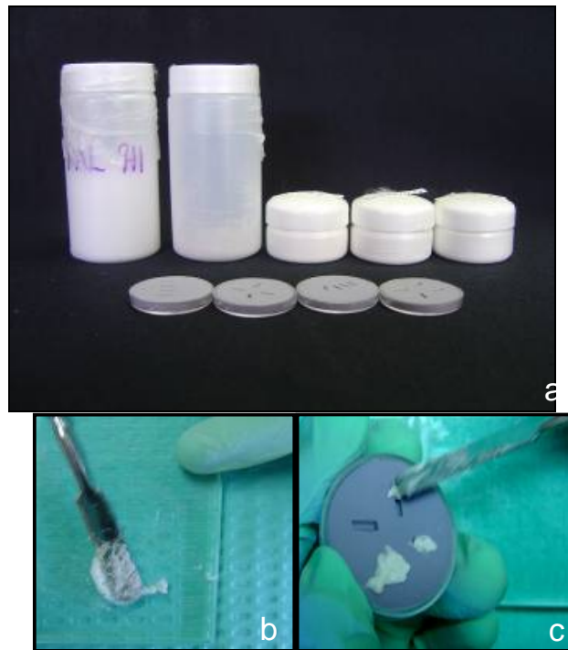
Fotografía 4.- Preparación de las muestras; a) recipientes donde se almacenan los polvos del material y hacedores de muestras, b) mezcla homogénea del material con agua desionizada, c) colocación del material en los hacedores de muestras.
