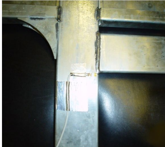
Figura 4-16. Probeta instrumentada junto a la zona de la grieta.
