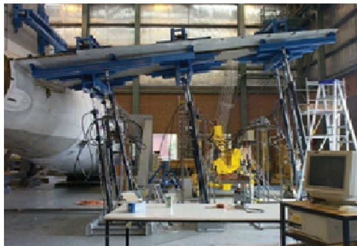
Figura 1-4. Prueba de fatiga en una ala de avión.
