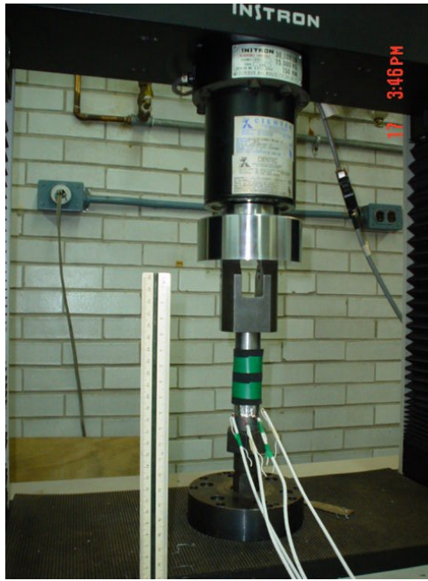
Figura 4-18. Celda de carga colocada en la máquina universal.
