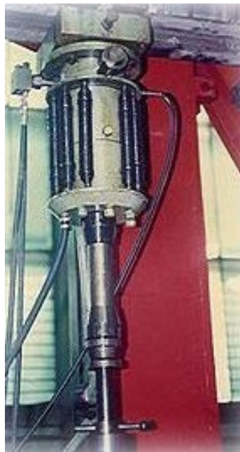
Figura 1-5. Actuador hidráulico utilizado en pruebas de fatiga.
