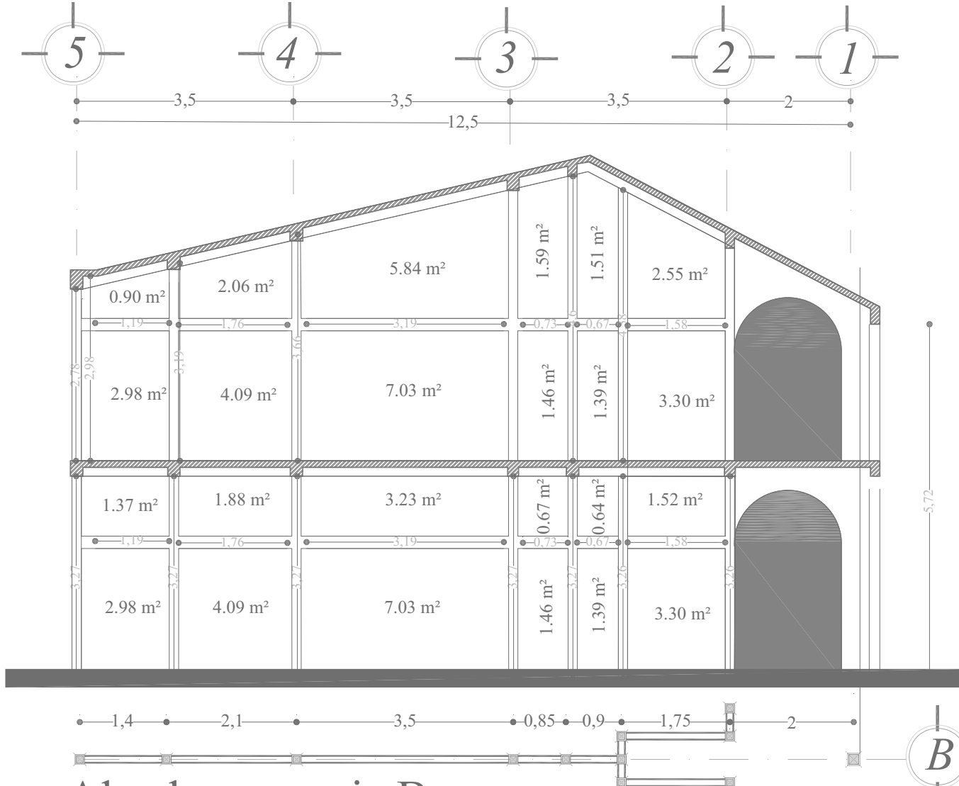
Alzado muro eje B
