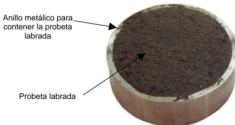
**Fotografía III.2.4.2.2 Labrado de la muestra de Suelo para obtener la probeta contenida en el anillo metálico**
