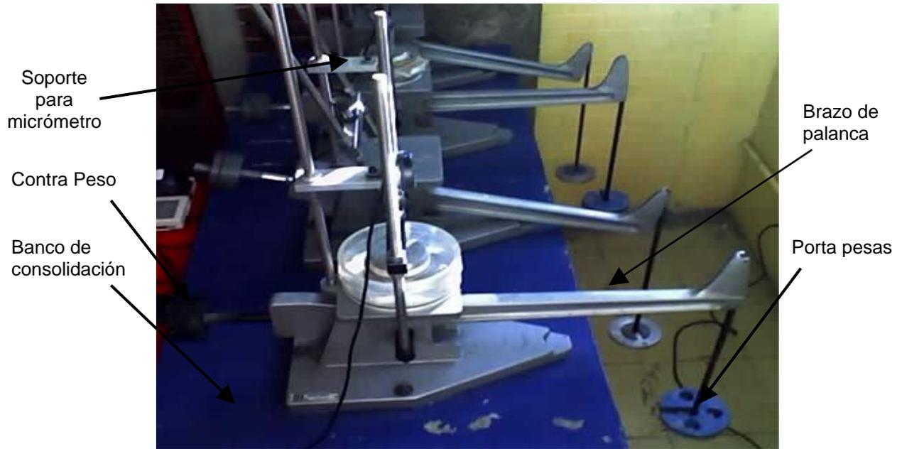
Fotografía III.2.4.1.1 (A) Consolidómetro (Vista lateral).
