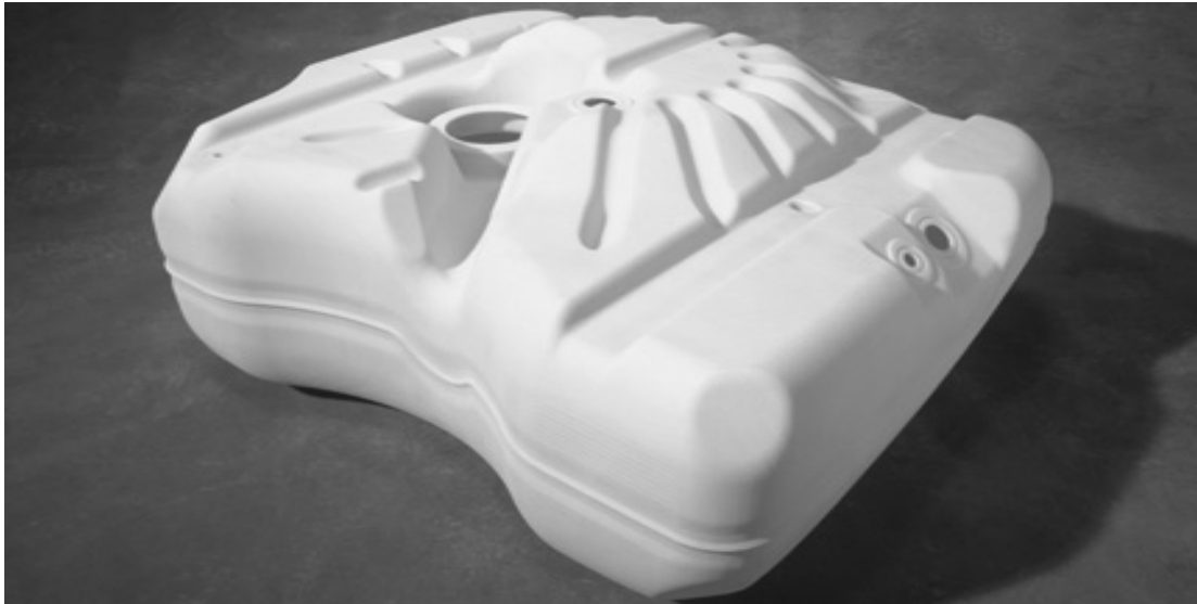
Figura 5.5 Tanque de gasolina proyecto desarrollado en una máquina EOSINT P 700 con material PA 2200(similar al poliéster).
