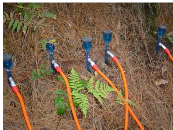
Figuras 5.23 y 5.24. En la figura 5.23 se observan los tensiómetros estándar y en la figura 5.24 los tensiómetros una vez que fueron automatizados (fotografías del autor).
