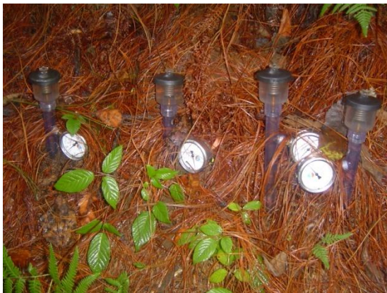
Figuras 5.23 y 5.24. En la figura 5.23 se observan los tensiómetros estándar y en la figura 5.24 los tensiómetros una vez que fueron automatizados (fotografías del autor).
