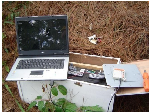
Figura 5.28. Instalación y configuración de la tarjeta de registro de datos (fotografía del autor).
