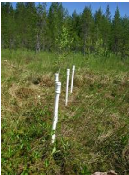
Figuras 4.9 y 4.10. Representación de la instalación y uso de un piezómetro. Fuente: biogeo.botanik.uni-greifswald.de y Mendoza et al. , 2002.
