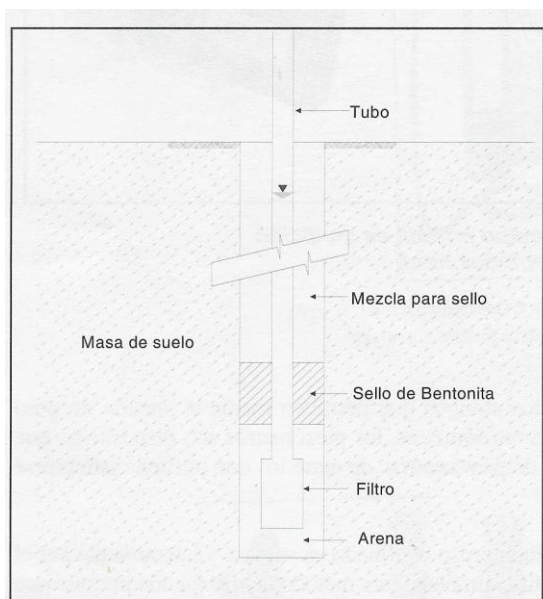
Figuras 4.9 y 4.10. Representación de la instalación y uso de un piezómetro. Fuente: biogeo.botanik.uni-greifswald.de y Mendoza et al. , 2002.
