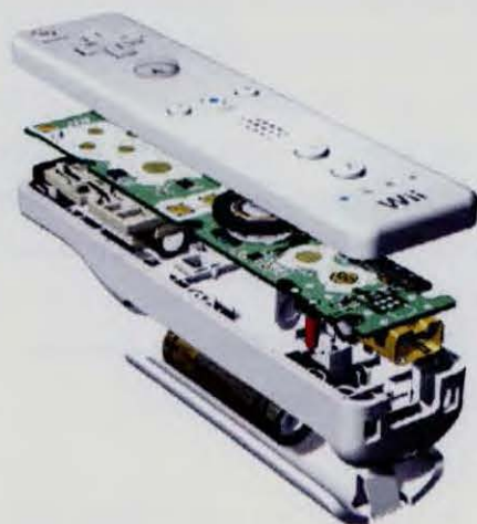
Figura 3.6: Wii Remote desensamblado
