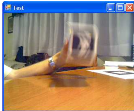
Figura 6.3: Patrón en movimiento circular a una velocidad aprox. de 100 vueltas por segundo con la cámara adquiriendo a 15 cuadros por segundo.
