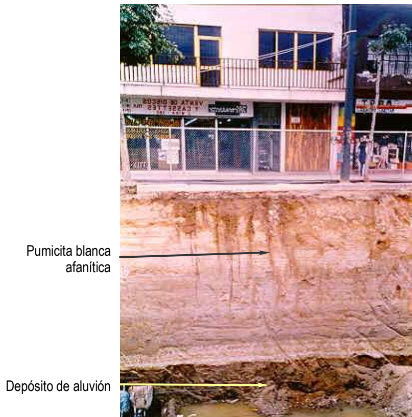
Foto 3.2. Pumicita de la Formación Tala y depósitos aluviales. Parte centro-norte de la ciudad de Guadalajara.
