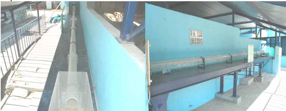
Figura 5.2 fotografías de la plataforma de apoyo para los túneles.
