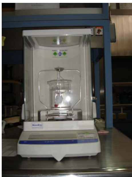
Figura 2.4. Báscula empleada para medir la densidad de las pastillas (marca: Mettler Toledo, modelo: AB104-SRS).
