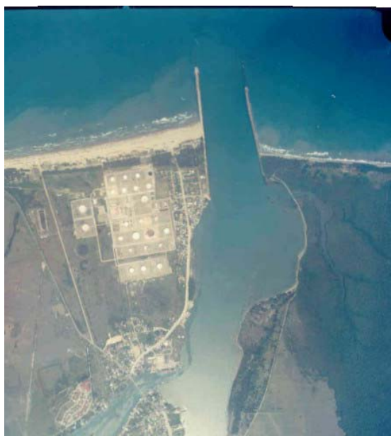
Figura. 2.13.- Escolleras en la desembocadura del Río Tuxpan
