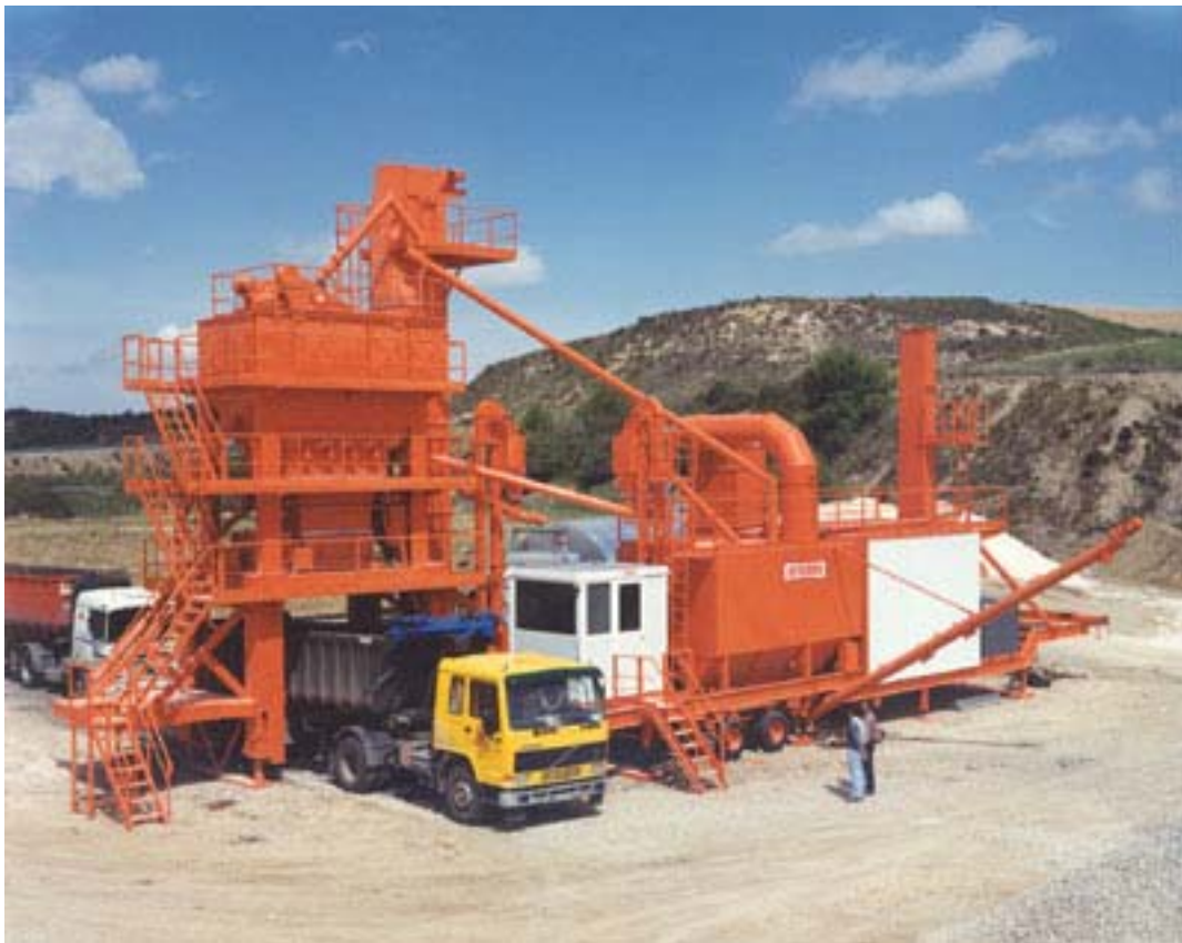
Planta de asfalto móvil.
