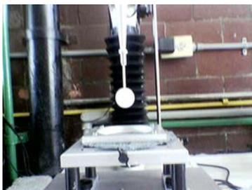
**Figura 16.** La muestra de Tortilla se coloca en la base del Texturometro previamente calentada 30 seg de cada lado, a una temperatura de aproximadamente 70°C
