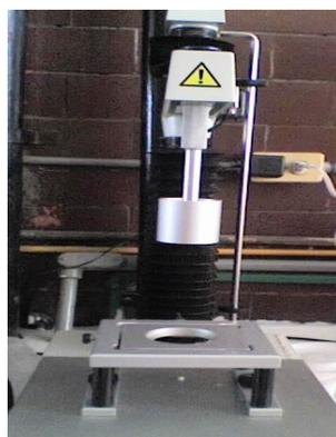
**Figura 18.** Sonda P/50, utilizada para la medición de TPA
