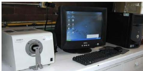
**Figura 10.** Espectrofotómetro minolta CM-3600d
