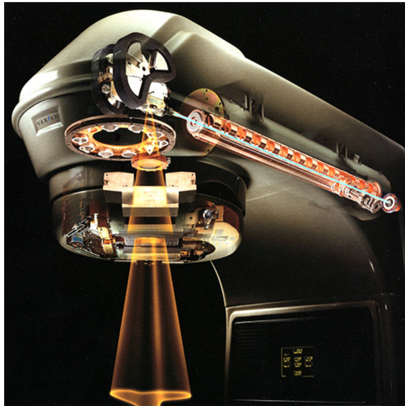
Figura 1.3. Diagrama de un acelerador Varian.
