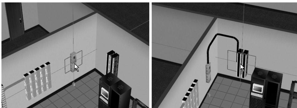
**Figura 4.28.** Caja de terminación y protección secundaria.
