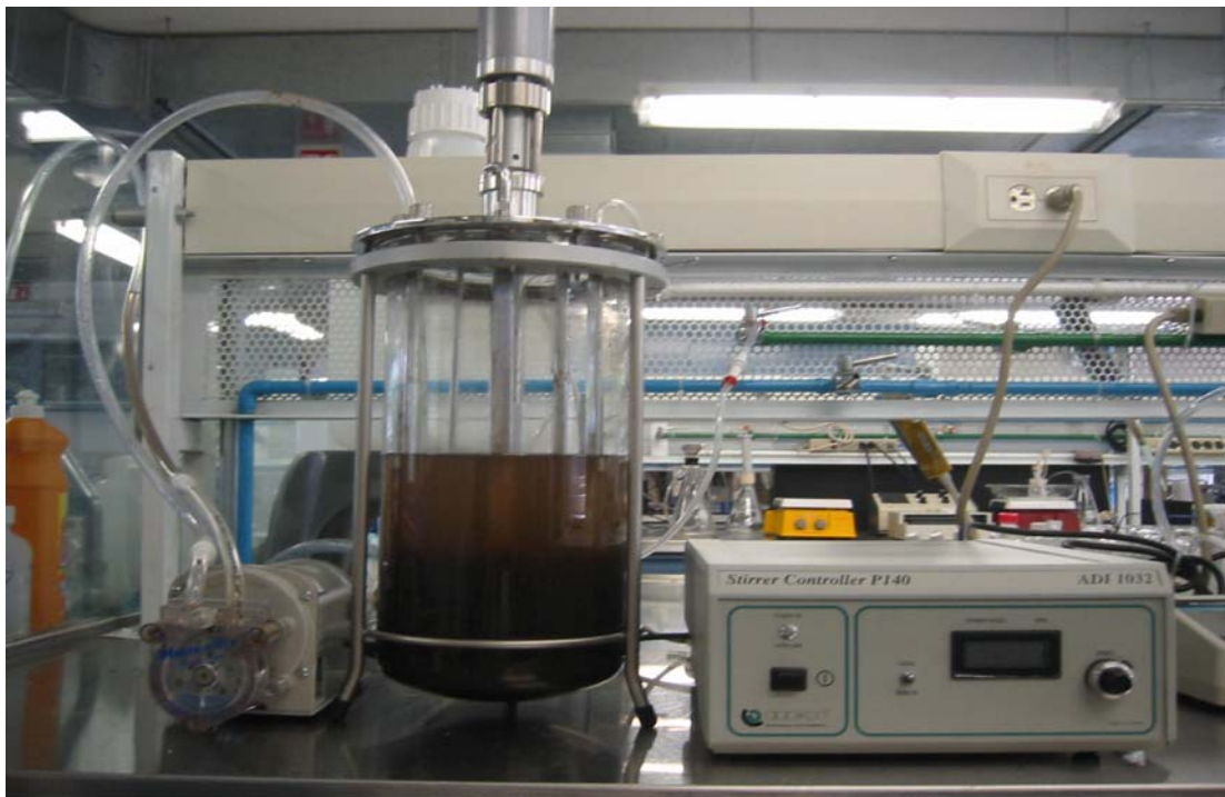
Figura 3.1. Sistema utilizado para la biodegradación de los compuestos amino aromáticos
