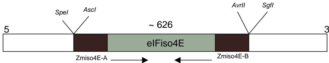
Figura 7. Diagrama del diseño del inserto *eIFiso4E* flanqueado por las enzimas de restricción *SpeI*, *AscI*, *AvrII* y *SgfI*. *Zmiso4E-A* y *Zmiso4E-B* son los cebadores diseñados para amplificar el inserto.
