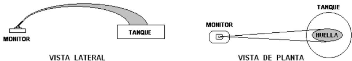
Figura 2.15 a. Técnica de Huellas para Aplicación de Espuma Tipo III.
