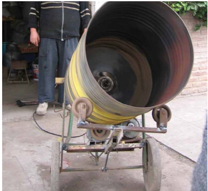
Secadora: centrifugación y abasto con aire calentado con gas
