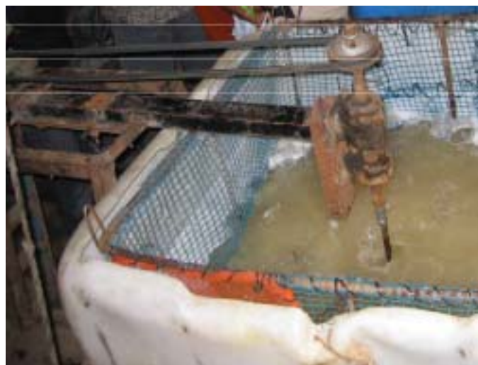
Lavado: Con un taladro se mueven las los vasos en un recipiente, la jaula interior se deja subir.
