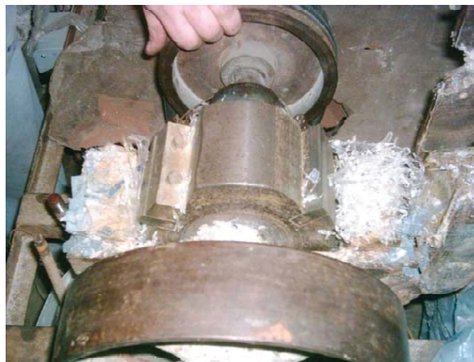
Trituradora: una motor viejo de un camión equipado con cuchillas
