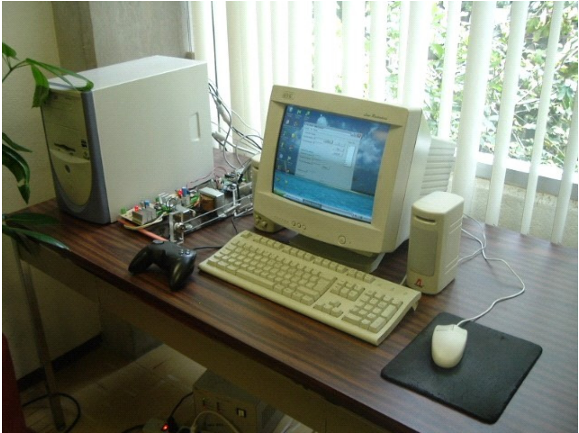
Figura 2. Prototipo experimental para el control de movimiento en motores CD con aplicación en MMC.
