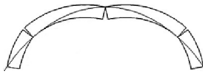
Figura 3.4 Mecanismo de falla de un arco semicircular simétrico
