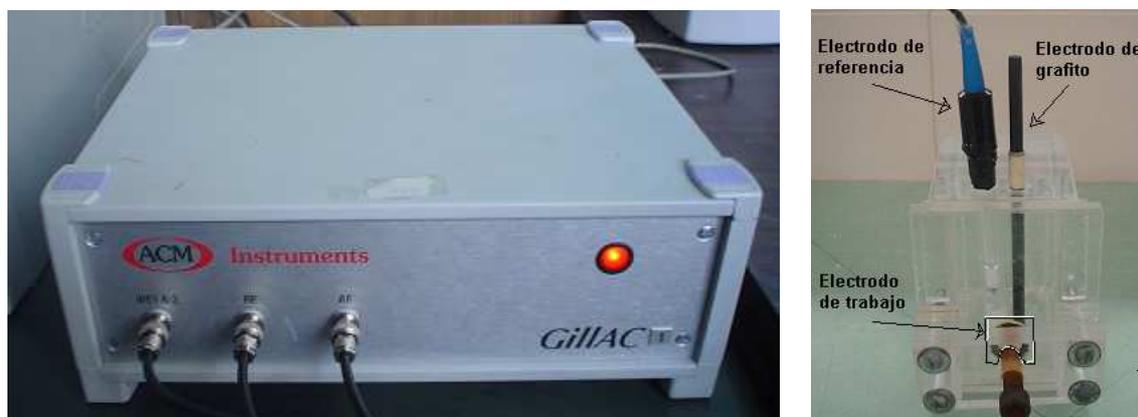
**Fig. 3.2** Equipo utilizado: a la izquierda se muestra un potenciostato, a la derecha la celda de trabajo con los tres electrodos, de referencia (calomel saturado), de grafito y de trabajo.
