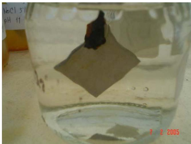
**Fig. 3.3** Espécimen metálico inmerso en una solución de trabajo.
