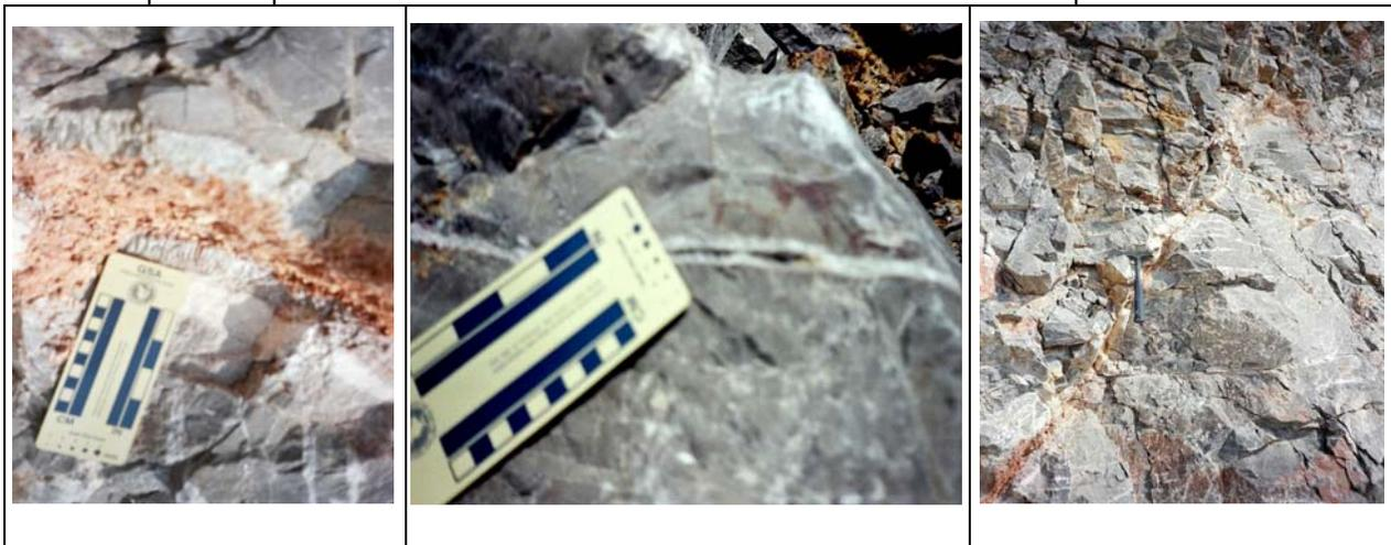
Fotos donde se puede observar el relleno de calcita recristalizada en fracturas y el intenso fracturamiento en la roca caliza.
