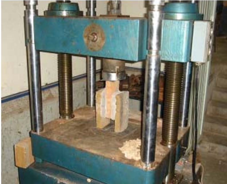
Figura 12.- Procedimiento de ensayo para determinar la adherencia
