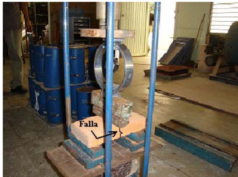
Figura 15.- La falla se presento en una zona cercana al centro de la pieza
