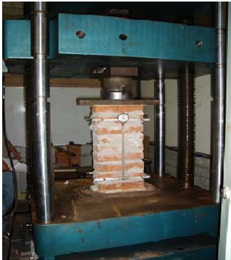
Figura 8.- Procedimiento de ensaye de una pila.
