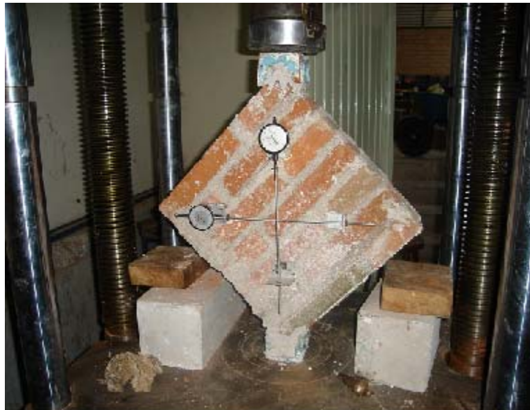
Figura 10.- Procedimiento de ensaye a tensión diagonal.
