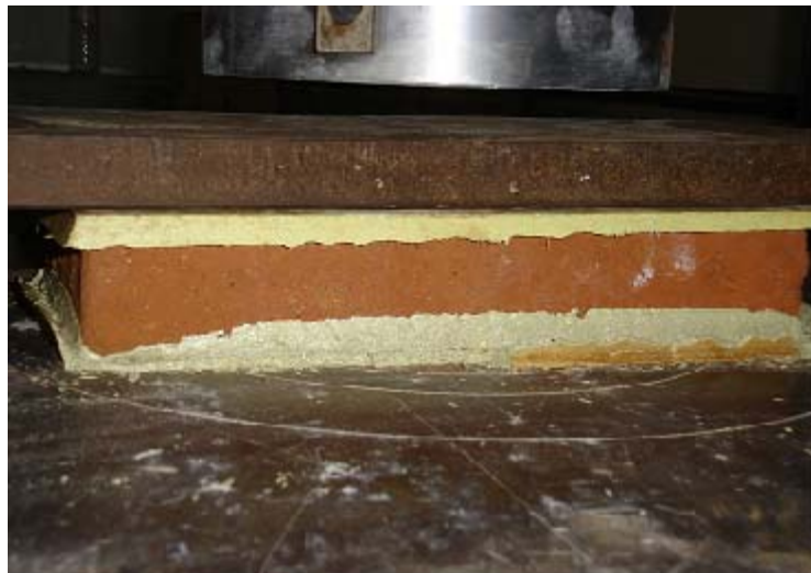
Figura 1.- Procedimiento de carga ensaye a compresión
