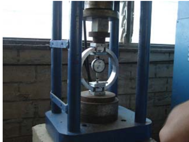
Figura 6.- Ensaye de cubo de mortero
