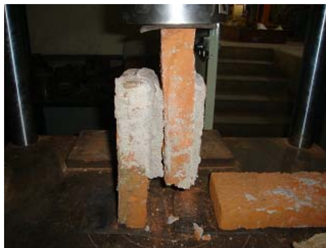
Figura 19.- Falla por adherencia del espécimen de 2.0 \text{ cm} de espesor de junta.
