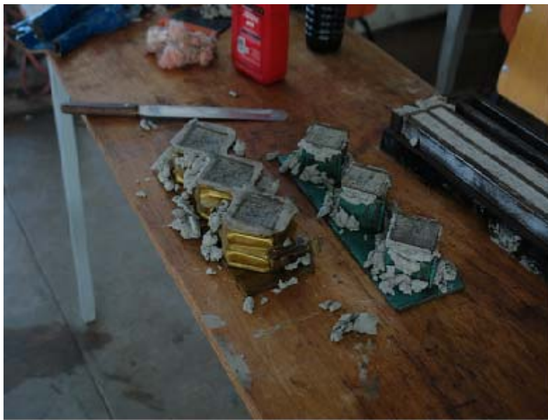
Figura 5.- Elaboración de cubos de morteros en moldes de cobre
