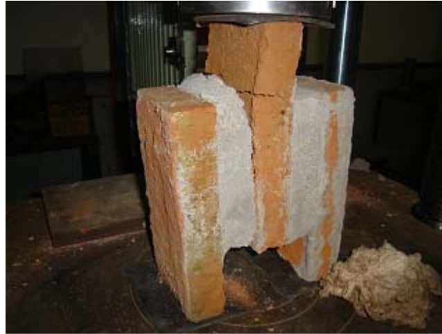
Figura 20.- Falla en la pieza central del espécimen.
