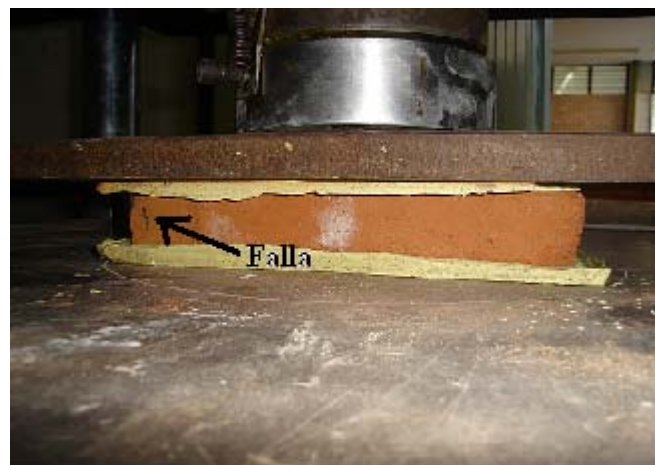
Figura 14.- Ensayo de pieza de tabique con falla localizada cercana a la esquina.
