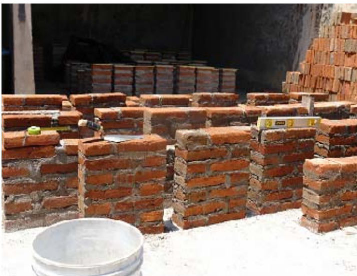
Figura 9.- Especímenes para la determinación de la resistencia a tensión diagonal
