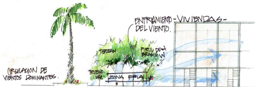
Fig. 13 Relación de las áreas verdes y vientos dominantes con las viviendas. Croquis.
