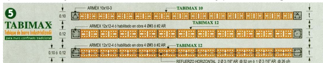
Fig. 22 Sistema de tabiques de barro extruido "Tabimax" de Novaceramic utilizados en la vivienda.
