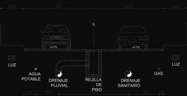
SECCION TIPO EN CALLES CERRADAS
