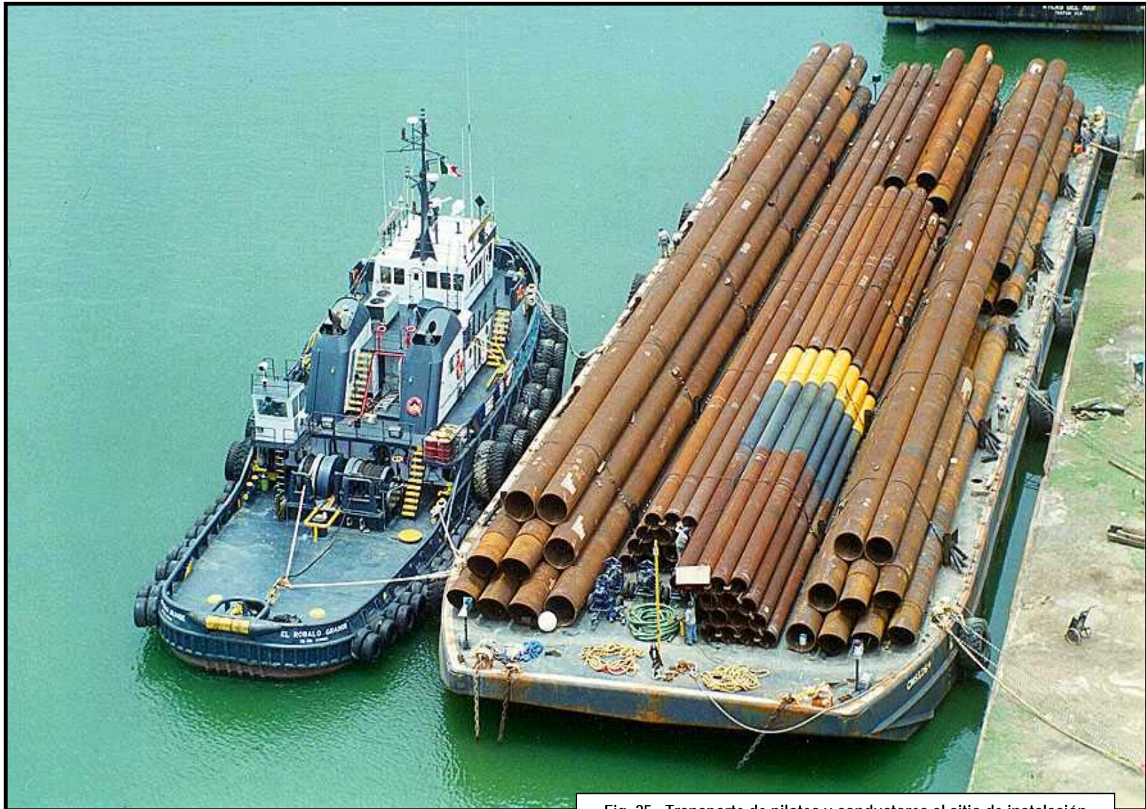
Fig. 25 Transporte de pilotes y conductores al sitio de instalación
